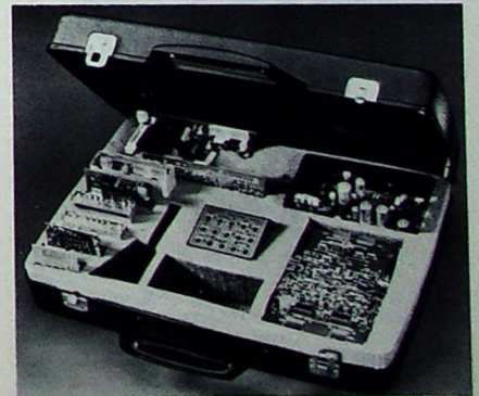
Bild 3. Servicekoffer zur Aufnahme der 11 wichtigsten Module und des Diagnose-Testers
